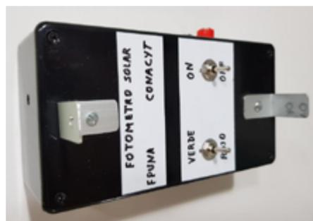
Figura 4. El fotómetro solar y sus partes constituyentes: (a) Llave de prendido/apagado, (b) Llave de conexión al canal V/R, (c) Orificio para apuntamiento, (d) Marcas de incidencia del haz de luz solar, (e) Orificio de entrada de la luz a la caja y (f) Terminales de salida del fotómetro para conectar al multímetro. Fuente propia.
