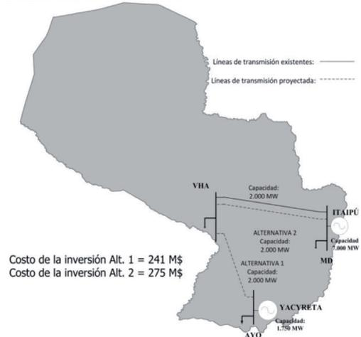
Figura 1. Alternativas de expansión del ST paraguay. En situaciones de déficit de energía, el precio del déficit es fijado en el valor de VOLL (*Value of*
