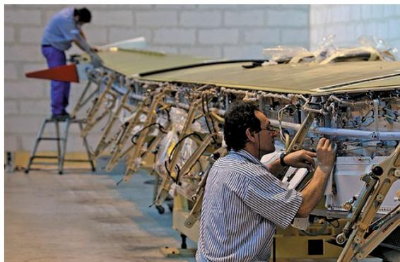
Ensamblaje de alas de una aeronave
