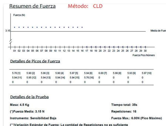
Fig. 7. Porción del informe proveído por el software una vez concluida el estudio de fuerza de una de las piernas. Método CLD: Cuádriceps Lado Derecho.
