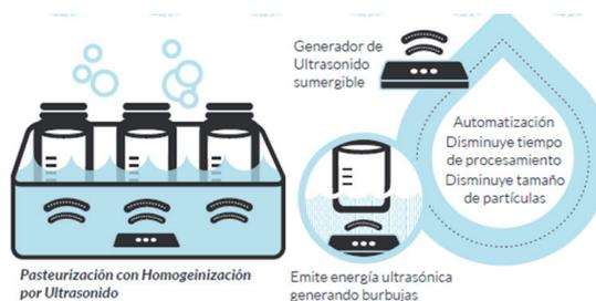
Fig. 1. Pasteurizadora con homogeneizador por ultrasonido
