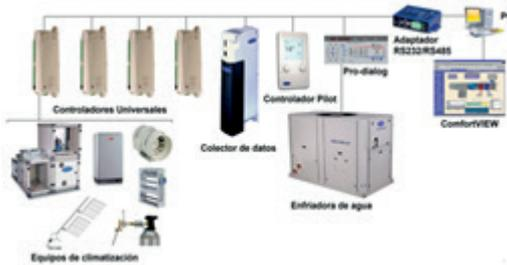
Fig. 5. Arquitectura del sistema de control basado en el sistema Carrier Comfort Network de la marca Carrier.
