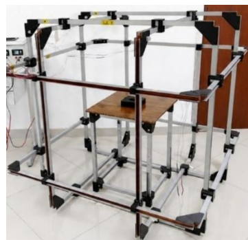
Figura 1 - Implementación física de la jaula de Helmholtz triaxial compuesta por tres pares de bobinas ortogonales anidadas.
