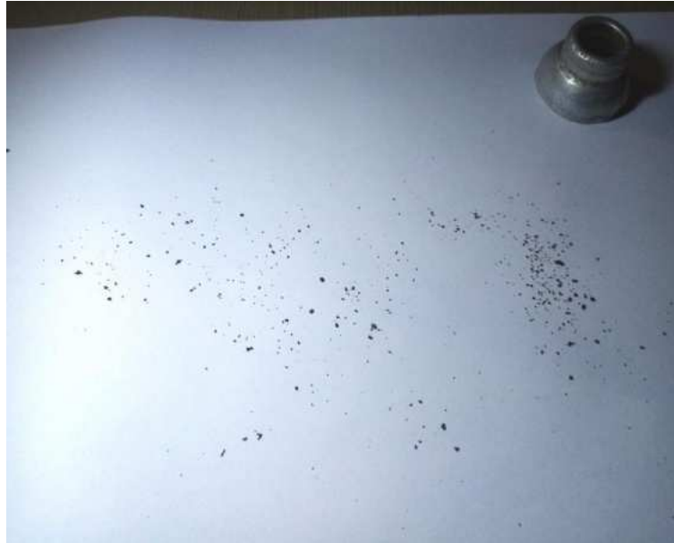
Utilización de imanes para la separación de partículas de hierro y litio.
