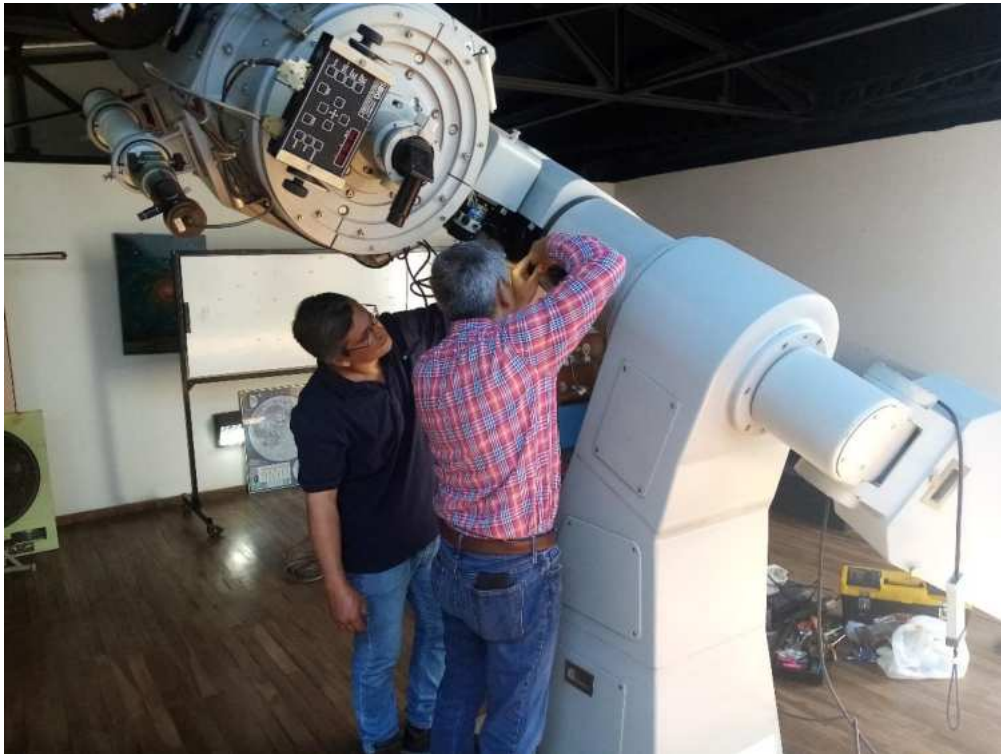
Etapa de limpieza y pulido del eje principal dañado.
