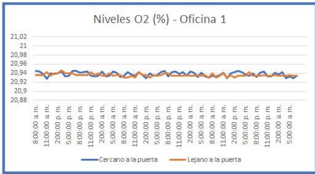
Figura 4. Mediciones de niveles de oxígeno tomadas con dos dispositivos en ubicaciones diferentes, durante el monitoreo en la oficina 1. 4
