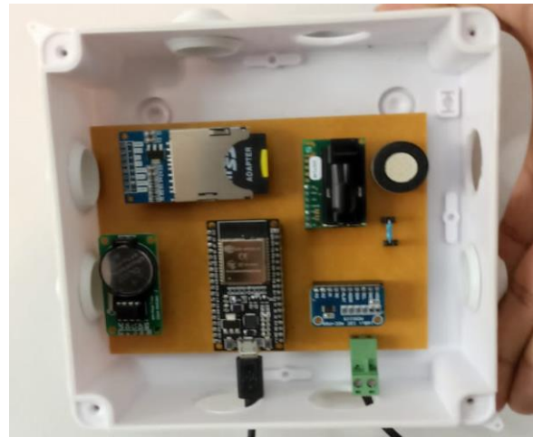
Fotografía 1. Diseño del primer prototipo utilizando un ADC ADS1115. 6
